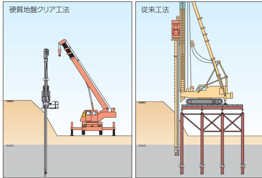
道路改良工事などの傾斜地での施工では、完成杭上を自走移動しながら施工が可能なので、仮設栈橋が不要で周辺環境への影響を最小限におさえて施工を完了することができます。
