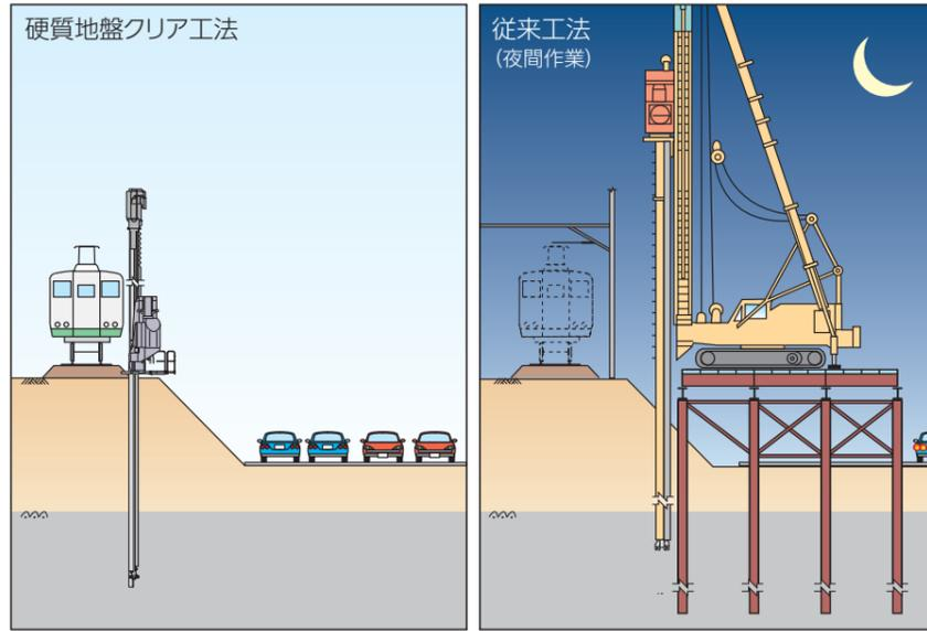
特に安全性が要求される鉄道工事では、機械が軽量・コンパクトで、転倒の危険性のない硬質地盤クリア工法であれば、供用中でも安全・確実に施工を行うことができます。
