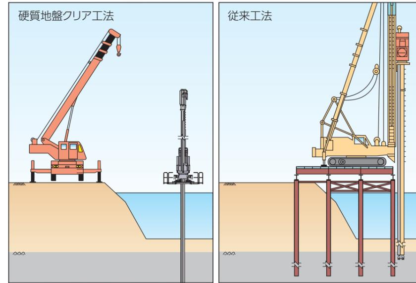
護岸改修工事、仮締切工などの河川内での施工では、完成杭上を自走移動するシステム機器を用いたGRBシステム施工を採用すれば、仮設栈橋が不要で大幅な工期・工費短縮を実現できます。
