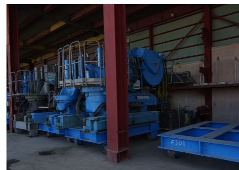
▲圧入機はトロッコ台車で簡単に収納
